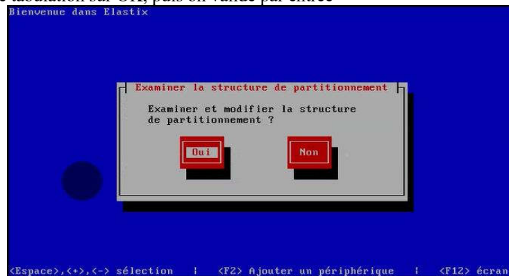
Figure N°23 : Configuration du serveur par Elastix/ examiner la structure de partitionnement
